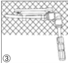
Anschließend kann die Durchführung mit den zu- und ablaufenden Schläuchen verbunden werden. Die Düsen und der Schlauch können mit Hilfe der Saugnapfe (Bild 1/Glasabdeckung) oder der Befestigungselemente (Bild 2 und 3, Holz oder Gaze) im Terrarium installiert werden.
